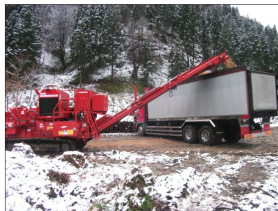
自走式木材破砕機による破砕・積込の様子
