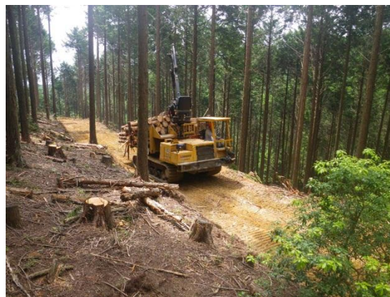
フォワーダによる運材作業
