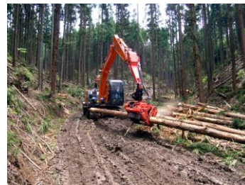
【プロセッサによる枝払い・造材】
