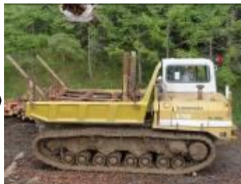
【クローラダンプによる運搬】 (荷台に改良型ステッキを搭載)
