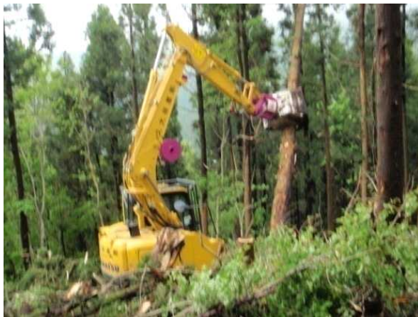
【伐倒機付及びバケット付きグラブによる先行伐倒】
