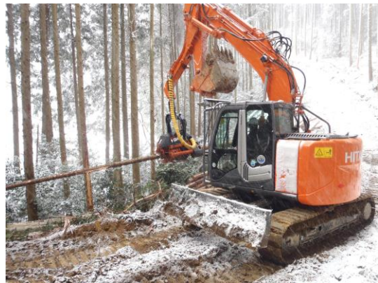
【ハイブリッド機による伐木・造材】
