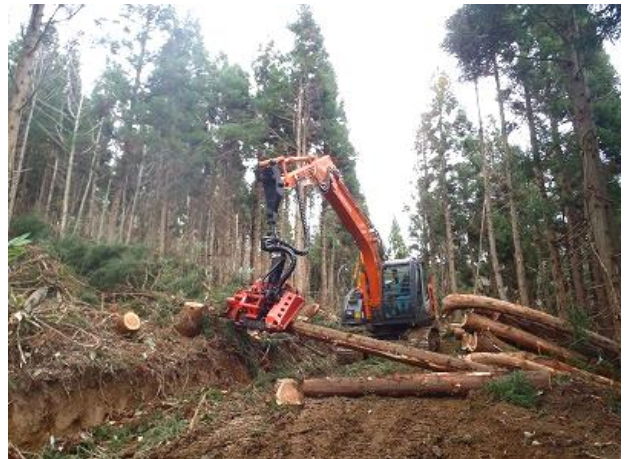
【ハーベスタによる伐倒・造材状況】
