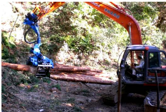
【作業道上でのハーベスタによる造材】
