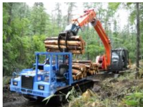
【スイングヤードによるフォワーダへの積込】
