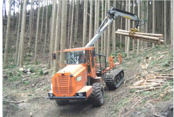
【積込み作業中のフォワーダ】
