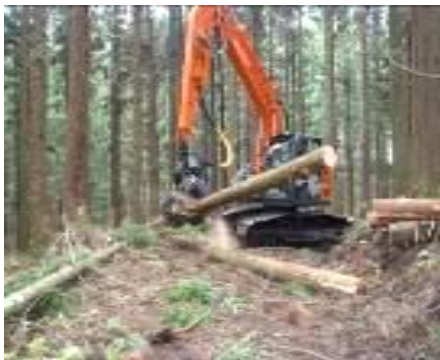
ハーベスタによる伐倒・造材作業
