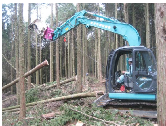
ウインチ付きザウルスロボの集材状況
