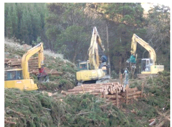
高性能林業機械による伐木・造材 (左からグラップル、ハーベスタ、グラップル)
