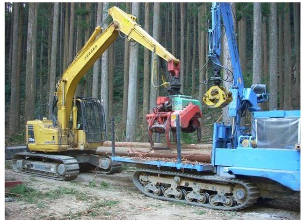
プロセッサ造材積み込み
