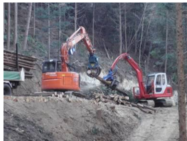
良材の造材はグラップルで補助
