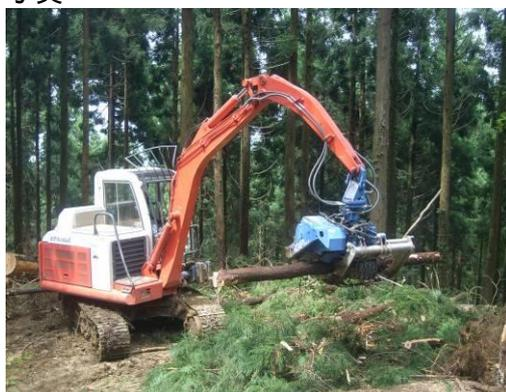
プロセッサによる造材作業(0.25 m<sup>3</sup>)
