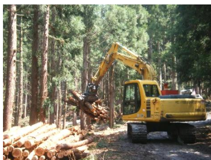
グラップルによる集材作業状況
