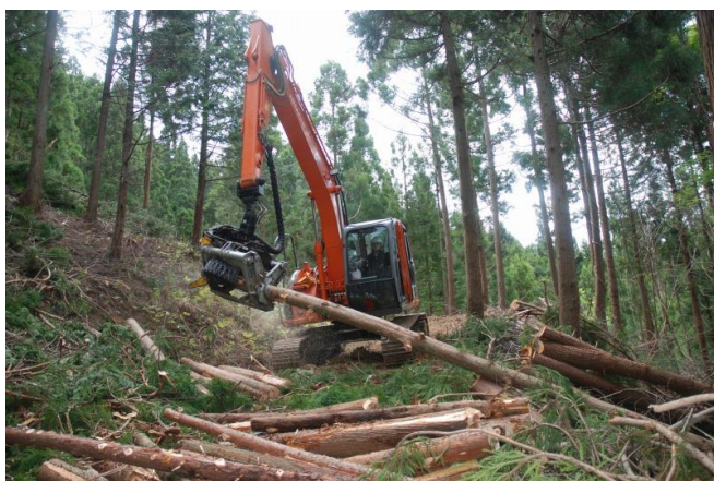
全幹集材した材をプロセッサによる造材
