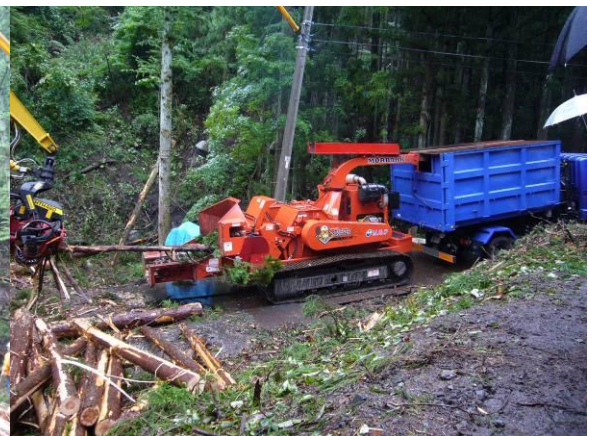
チップパー機を組合わせた作業システム
