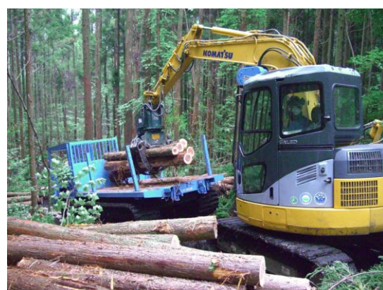
グラップルによる運材車への積み込み作業
