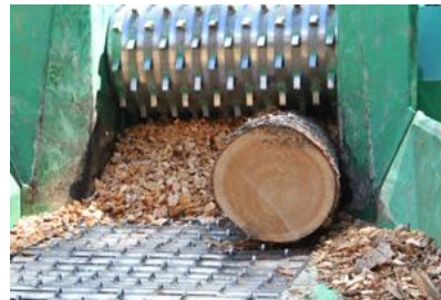
間伐材破碎時状況
