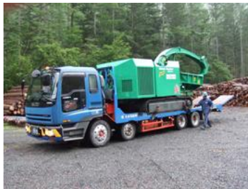
チップパー機運搬時状況
