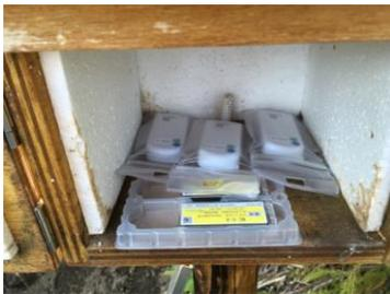
写真 2-2 収納箱内に設置したDシャトル
