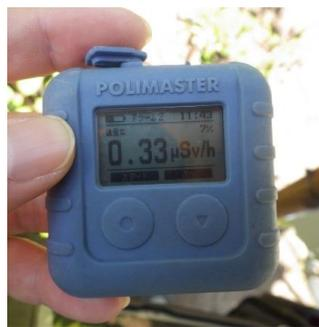
写真 2-3 併用した個人線量計 (Polimaster)
