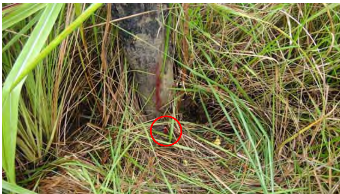
写真⑩-1 測点はなるべく目印となるもののそば、目立たないように設置
