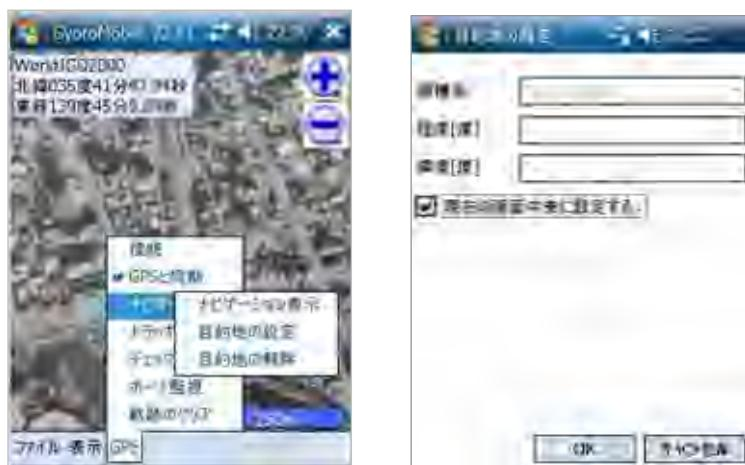
「GPS」→「GPS と同期」を選択し、さらに「ナビゲーション」→「ナビゲーション表示」を選択すると、下図のように目的地まで直線が引かれ、距離や方位も表示されます。さらに「GPS」→「トラッキング」→「開始」を選択し、軌跡の記録を開始します。
