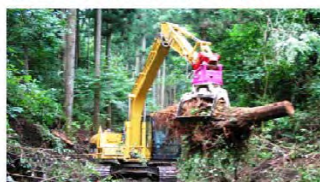
ザウルスロボによる作業道の作設
