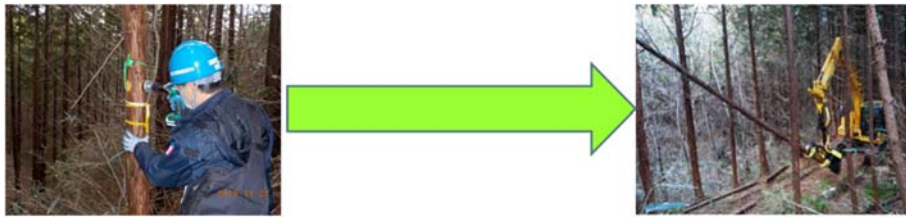
(図-6) ①森林作業道から5 m以内はハーベスタで伐倒、集材
