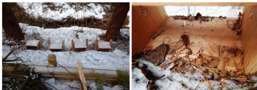
（写真-5）約3ヶ月間設置した土砂受け箱
