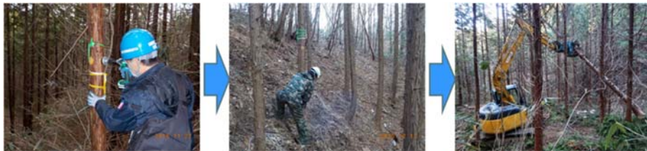
(図-7) ②森林作業道から5～20 mの範囲はチェーンソーで伐倒、グラップルで集材
