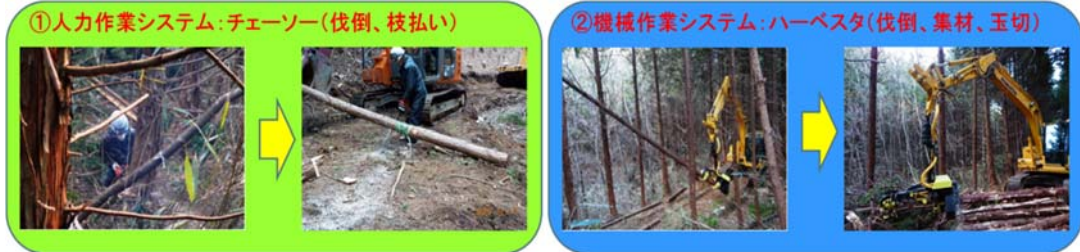
(図-5) 各作業システム
