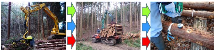
(図-9) ハーベスタで玉切、フォワーダで搬出、土場で樹皮採取
