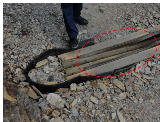
写真4 Ver. 2における鉄板の曲がり
