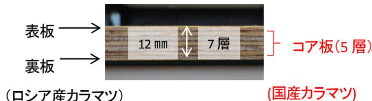
図2 平成27年度 国産針葉樹型枠用合板の断面
