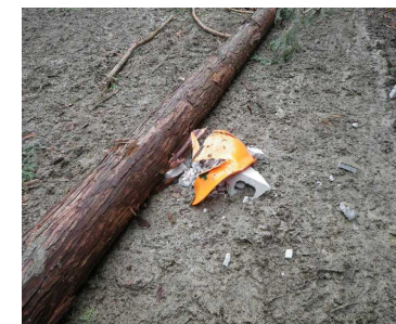
破壊された保安帽
