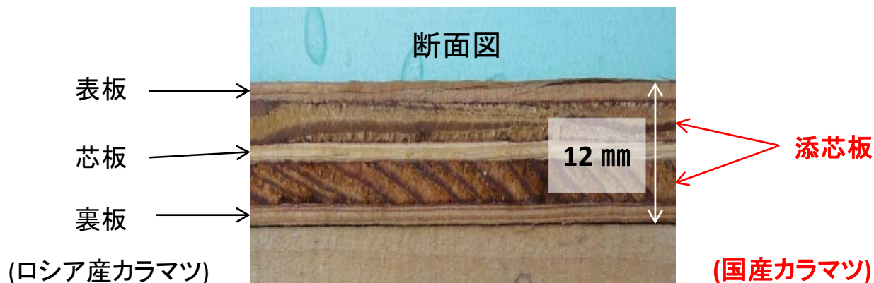
図1 平成26年度使用国産針葉樹型枠用合板の断面
