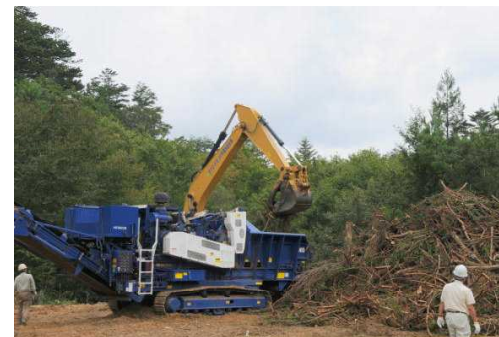
写真2 自走式チッパーによるチップ化
