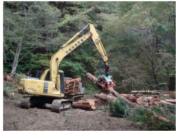
写真－8 林外での枝払い・造材作業
