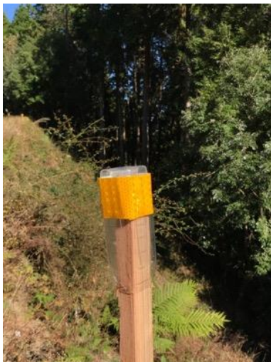
図 2.2.11 強反射材を巻きつけた木製杭
