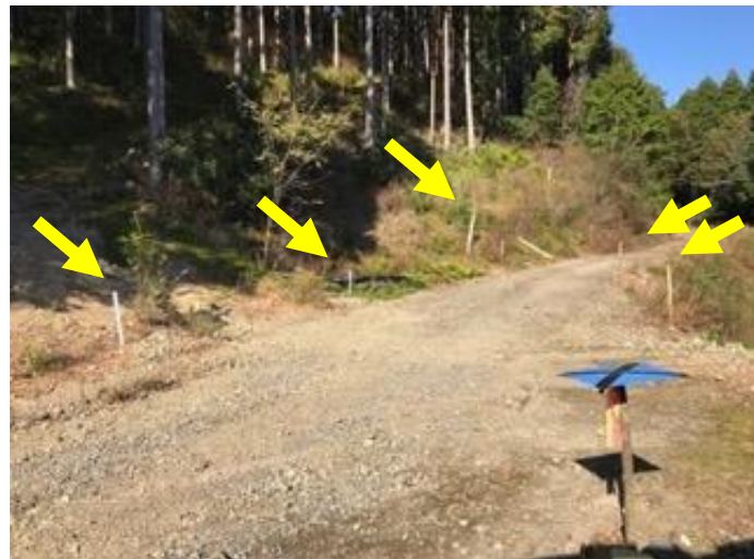
図 2.2.12 反射材を装着した杭の配置状況 矢印➡は杭の位置。右下は対空標識である。
