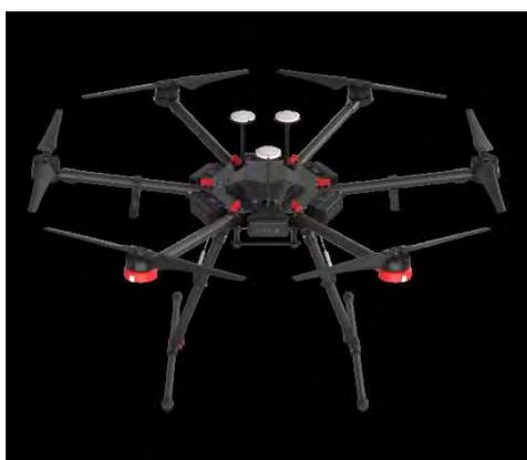
図3.2.2 レーザスキャナを搭載できる代表的なUAVの例
