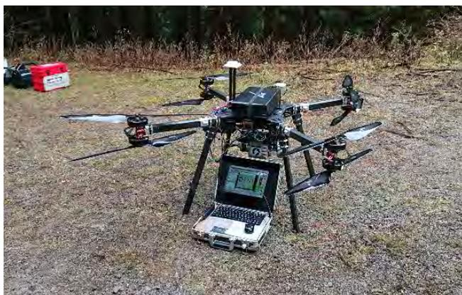
図3.2.1 レーザ計測器を搭載したUAV
