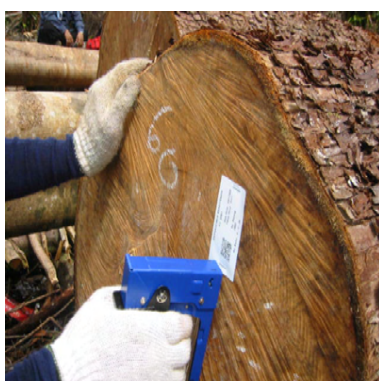
ガンタッカによるラベルの添付作業（針止め）
