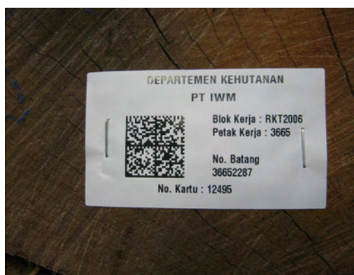
二次元バーコードの種類：DM コード インクの種類：セミレジン系 針止め数：2 針/ラベル
