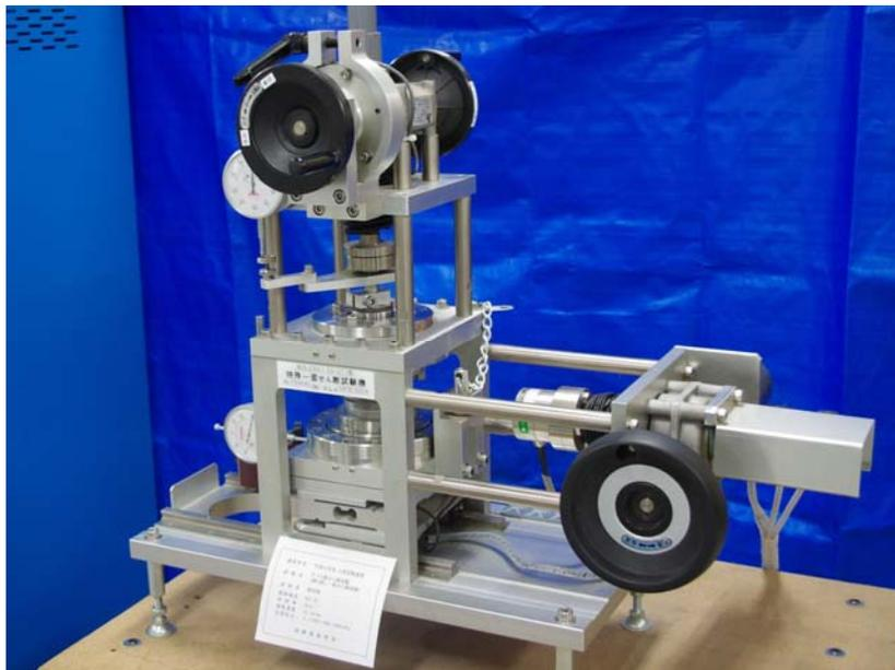
写真 3 すべり面せん断試験機
