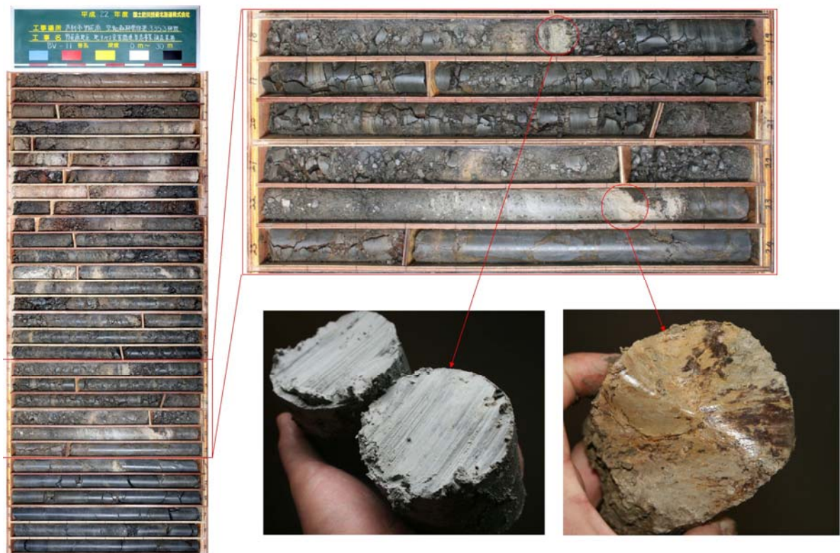
図 56 ボーリングコアにみられる 2 面のすべり面 (BV-11)
