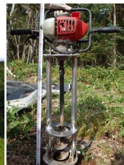
コンテナ苗植付用アタッチメントを取付けたオーガ
