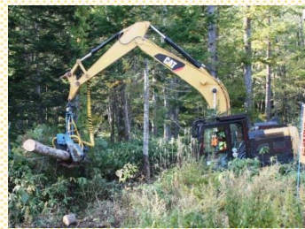
ハーベスタによる枝払い作業見学
