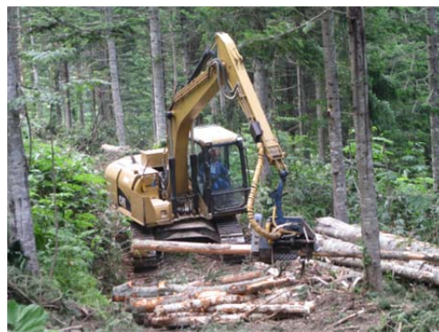
ハーベスタによる伐倒・枝払い・玉切りの状況
