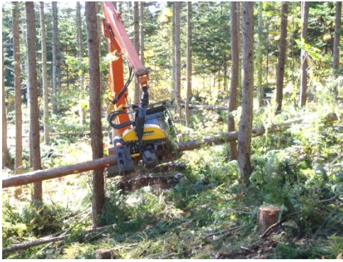
フェラーバンチャによる伐倒の状況
