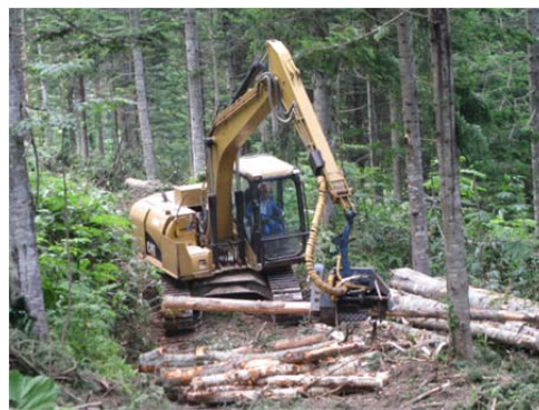
ハーベスタによる伐倒・枝払い・玉切りの状況
