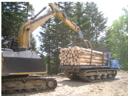
グラップルによるフォワーダへの積み込みの状況
