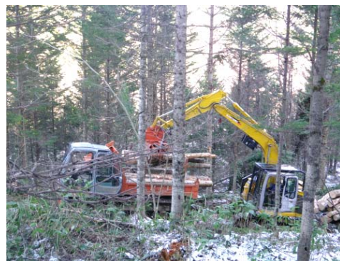
グラップルによるフォワーダへの積み込みの状況
