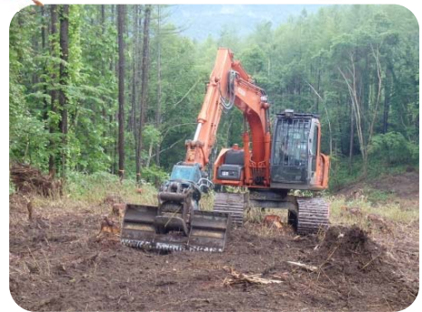
⑤伐採時に使用したの重機でササ等を除去し、地拵え時の重機運搬経費を削減
