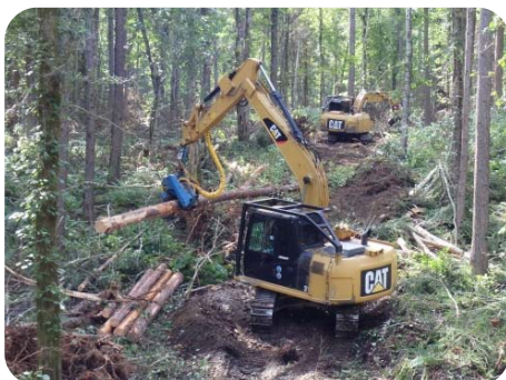
②伐採に伴う枝条を森林作業道脇に集積し、地拵えを省力化
