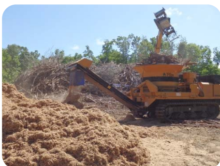
④森林作業道脇に集積された末木枝条を破砕機でチップ化し、販売
