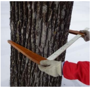
輪尺で直径を測る
