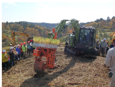
現在、開発・実用化が待たれる コンテナ苗の自動植付機
