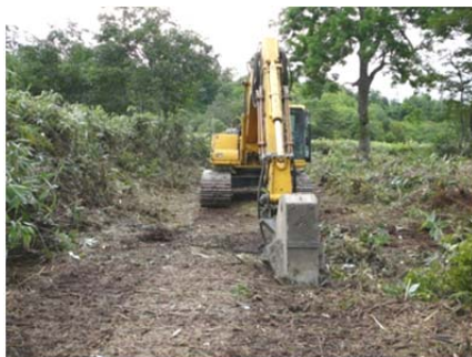
フラッシュカッターによる地拵
