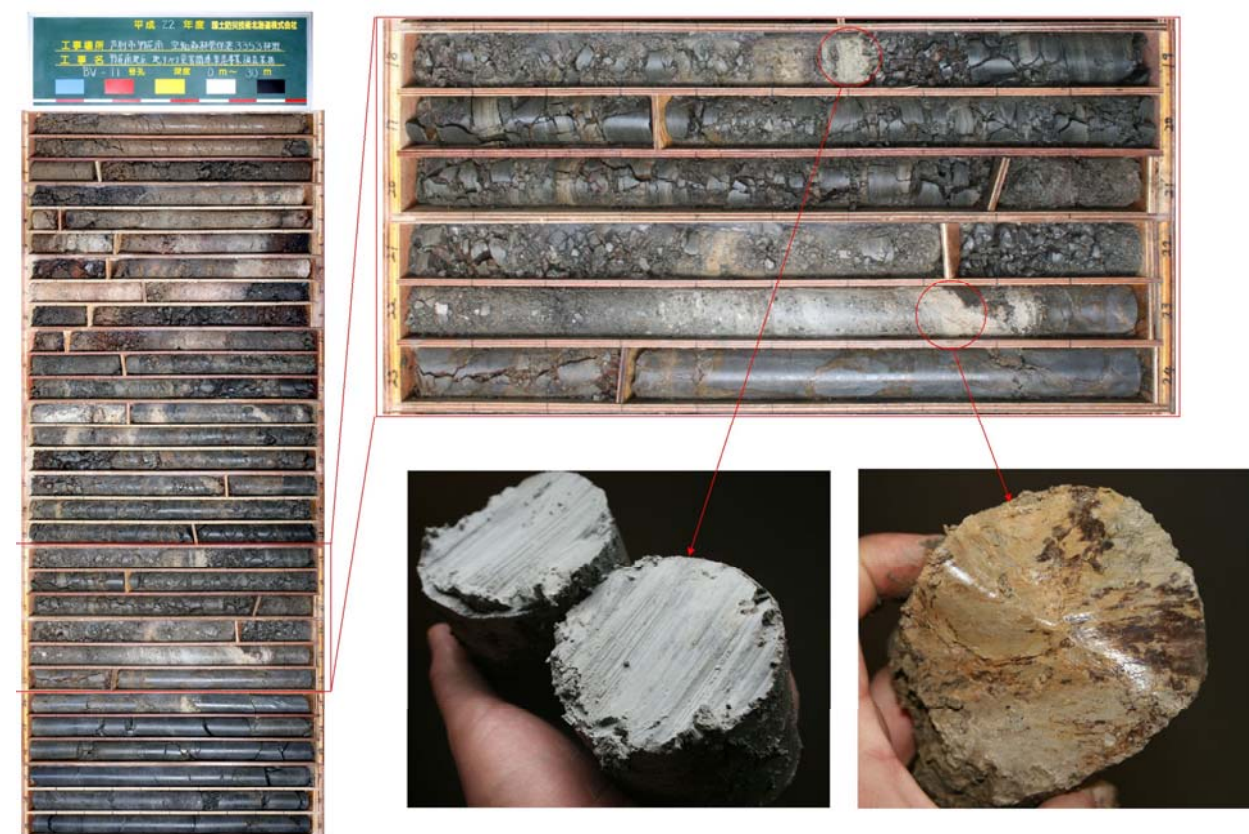
図 22 ボーリングコアにみられる 2 面のすべり面（BV-11）
