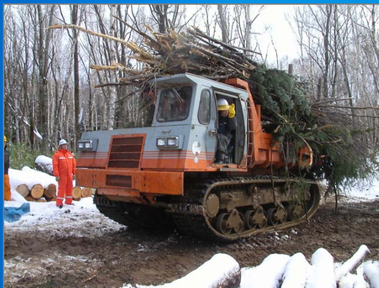
林内作業車による林地残材の収集
