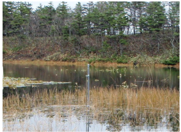
稚咲内海岸砂丘林の湖沼での水位計による水位調査
