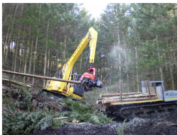
ハーベスタ（左）とフォワーダ（右）による集材の様子
